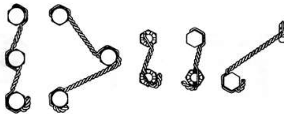
그림43. 볼트 와이어링 (Safety Wiring) 예시
