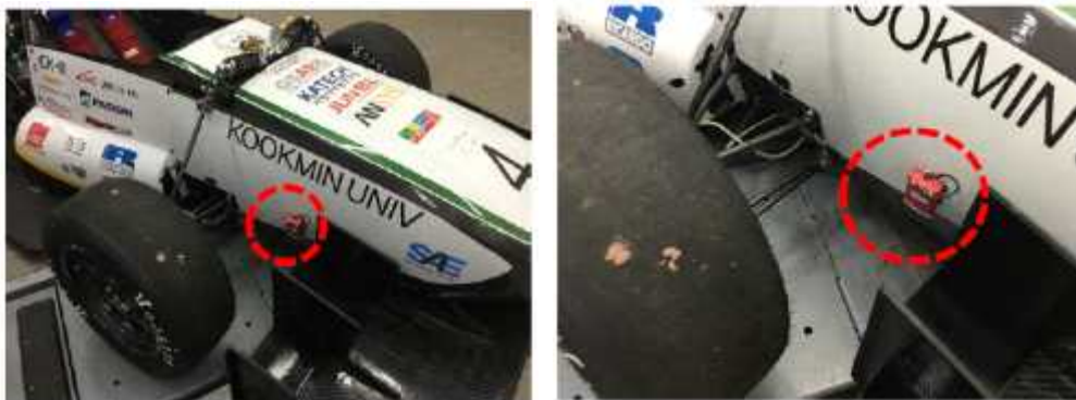
그림 41. 트랜스폰더 설치 위치 및 형상
