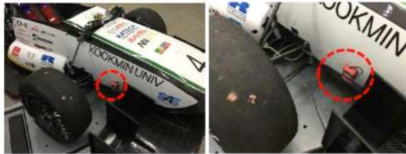
그림10. 트랜스폰더 설치 위치 및 형상
