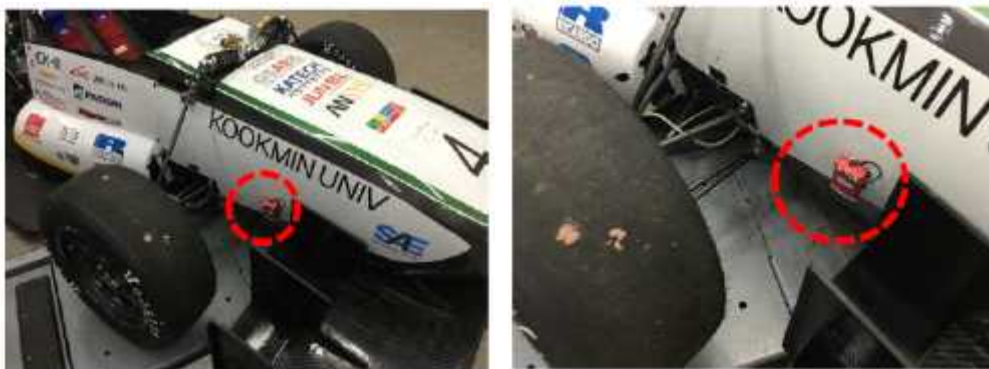
그림41. 트랜스폰더 설치 위치 및 형상
