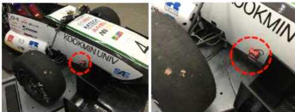
그림8. 트랜스폰더 설치 위치 및 형상
