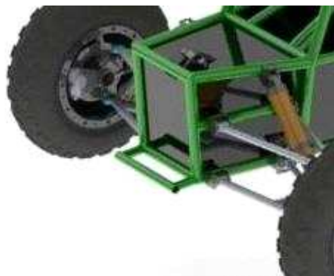
그림9. 견인 고리 형태 및 부착방법
