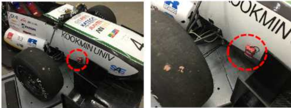
그림39. 트랜스폰더 설치 위치 및 형상
