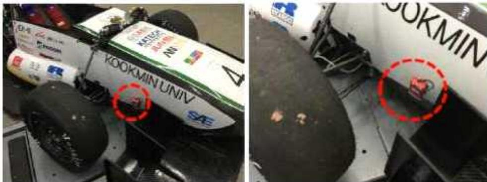
그림9. 트랜스폰더 설치 위치 및 형상
