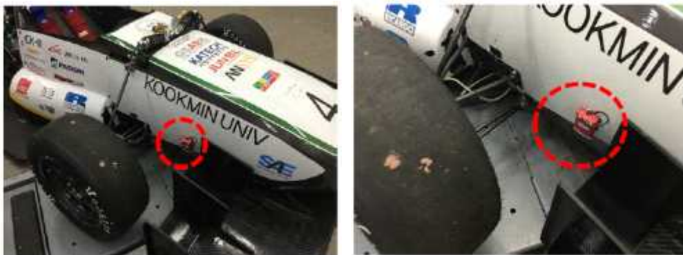
그림37. 트랜스폰더 설치 위치 및 형상
