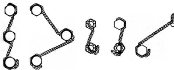
그림39. 볼트 와이어링 (Safety Wiring) 예시
