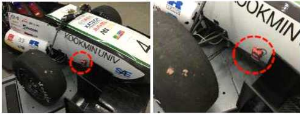
그림 10. 트랜스폰더 설치 위치 및 형상
