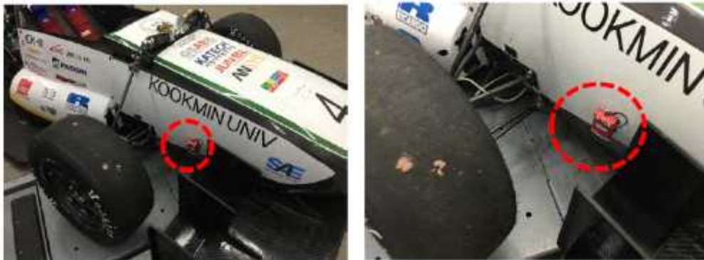
그림38. 트랜스폰더 설치 위치 및 형상
