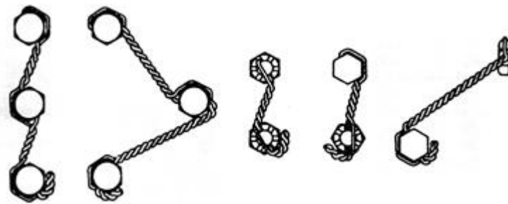
그림40. 볼트 와이어링 (Safety Wiring) 예시
