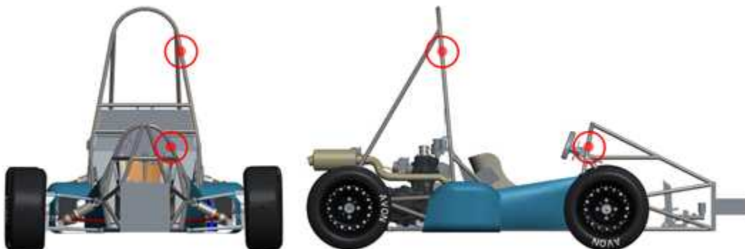
그림9. 메인 롤 후프 및 전방 롤 후프 검사구멍 위치
