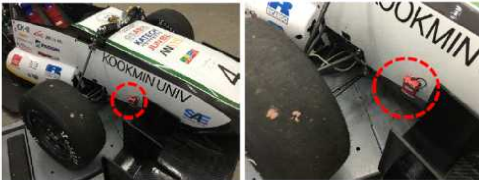
그림9. 트랜스폰더 설치 위치 및 형상
